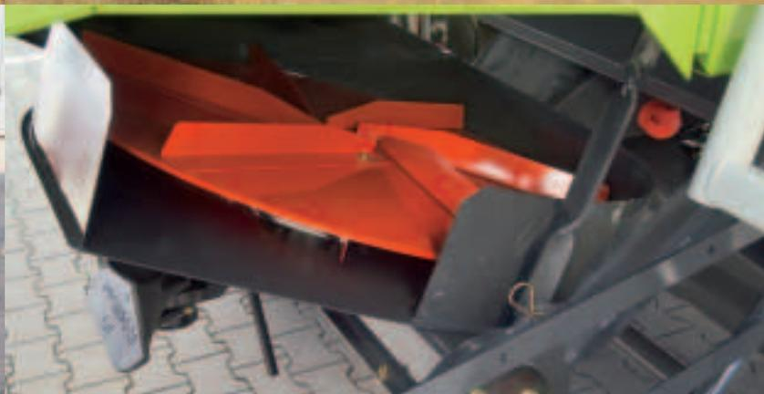
Soll das Stroh gehäckselt und auf dem Feld verteilt werden, wird der Strohhäcksler mit wenigen Handgriffen in Arbeitsposition gebracht. CLAAS Strohhäcksler zeichnen sich durch kurzes, exaktes Häcksel und gleichmäßige Verteilung über die gesamte Schnittbreite aus.
